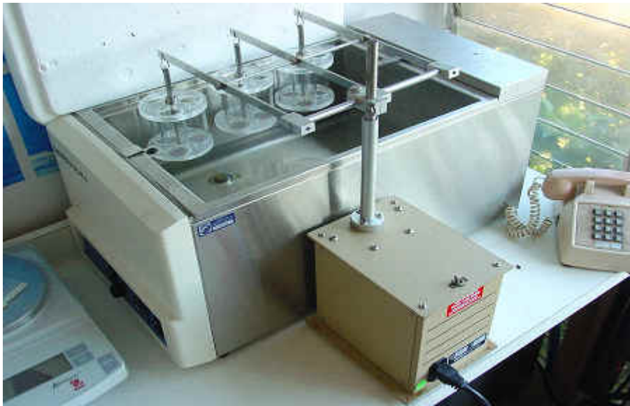
图 17 一种测试虾饲料颗粒水稳定度指标的修改装置
